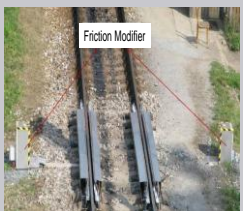
Reduzierung Bremsquietschen Ablaufberge Rbf.
