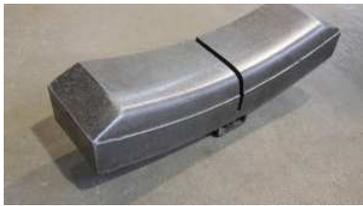
Neue Beläge aus Verbundwerkstoffen reduzieren das Laufgeräusch
