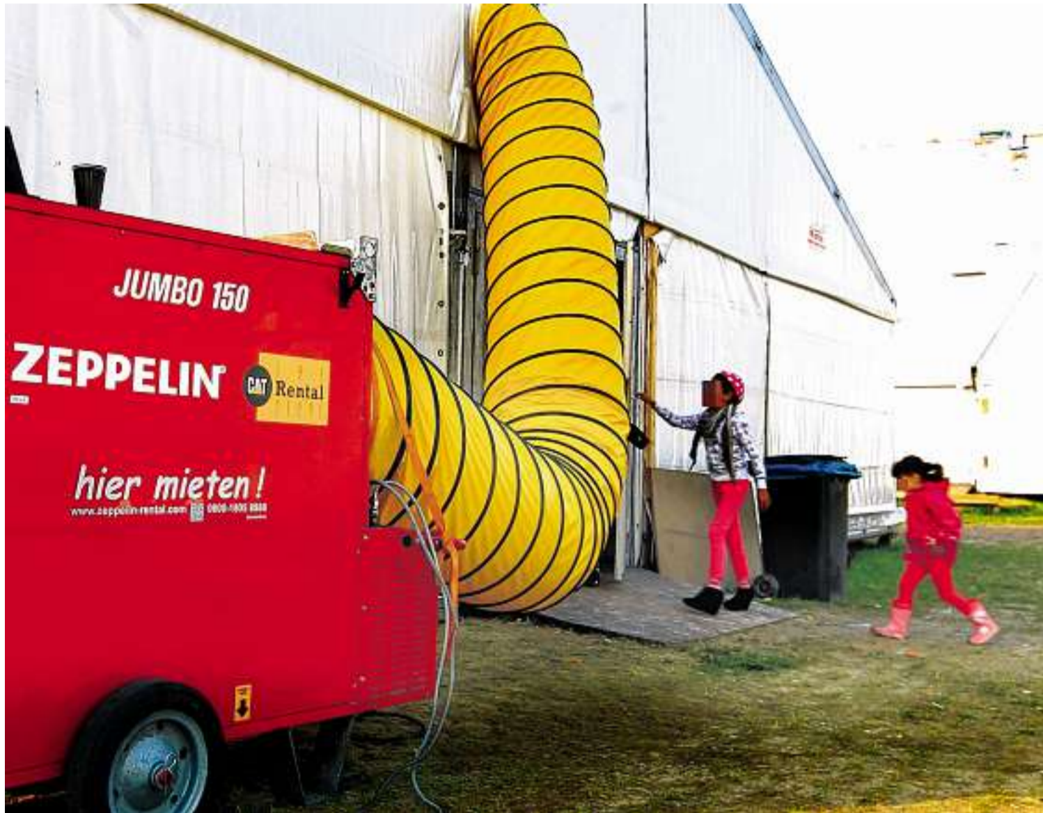
Über mobile Öl-Luftwärmehilfen werden die Flüchtlingszelte am Überseeort beheizt.
