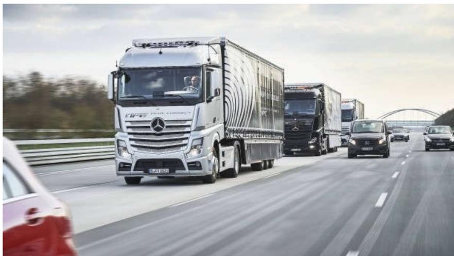
Laster mit Autopilot: Ein Mercedes-LKW mit dem Highway Pilot Connect-System
