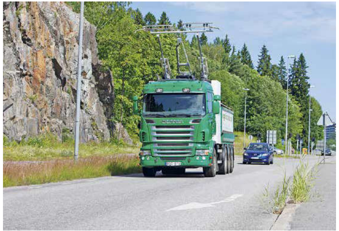
Erinnert schon sehr an die alten Oberleitungsbusse: Versuchslaster in Södertälje Foto: Scania
