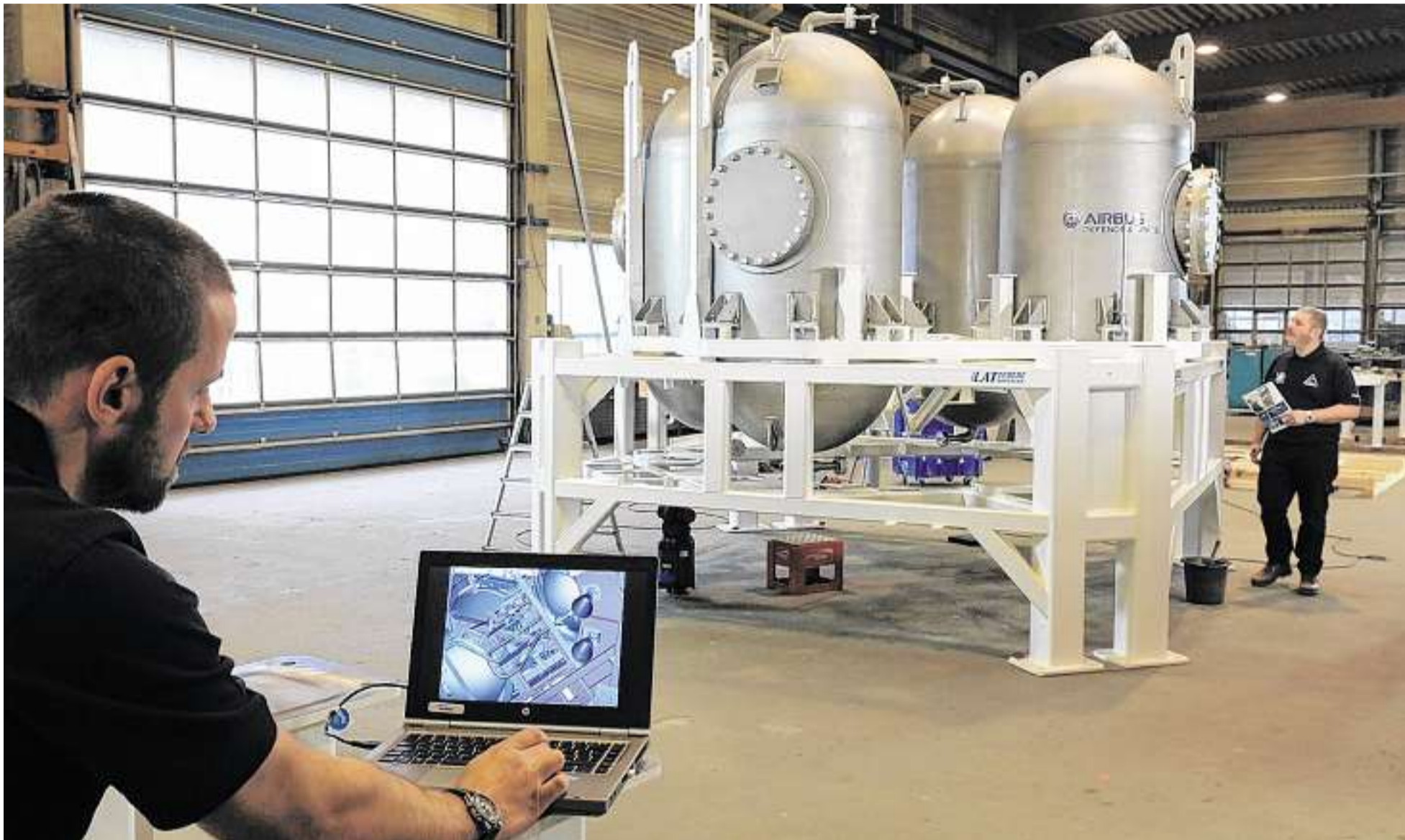
Die vier Edelstahl tanks, die in Bremen bei Anton Christophers gefertigt wurden, werden derzeit in die Hauptstruktur für das Test-Antriebssystem der Raumkapsel Orion integriert. FOTO: AIRBUS
