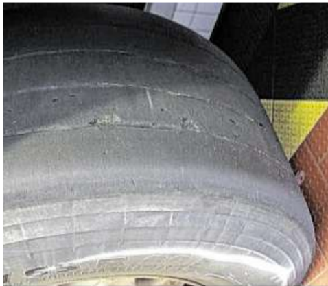
Die Reifen des Sattelzuges wiesen so gut wie kein Profil mehr auf. FOTO: POLIZEI
