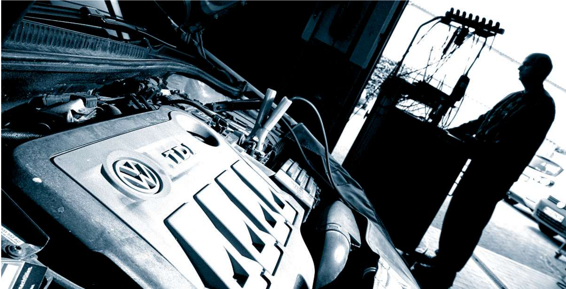
Ein Kfz-Meister lädt im Rahmen einer Rückrufaktion zum Abgasskandal ein Software-Update auf einen Volkswagen Golf mit einem 2,0-Liter-Dieselmotor.
