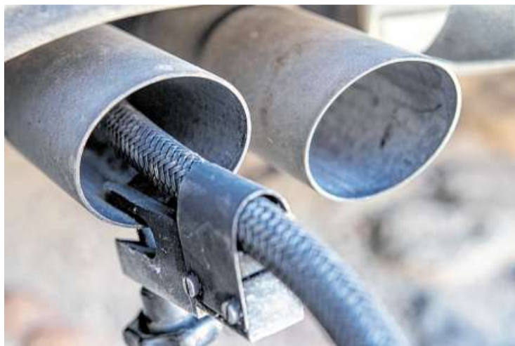
Abgasuntersuchung mit einem Messschlauch. Insgesamt hat die Organisation ICCT die Prüfergebnisse von 541 Pkw unter die Lupe genommen. FOTO: DPA
